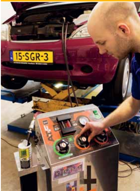
Harberink gelooft sterk in spoelen om schade te voorkomen. Daarom gebruikt en verkoopt zijn bedrijf spoelmachines voor zowel airco als automatische transmissie.
