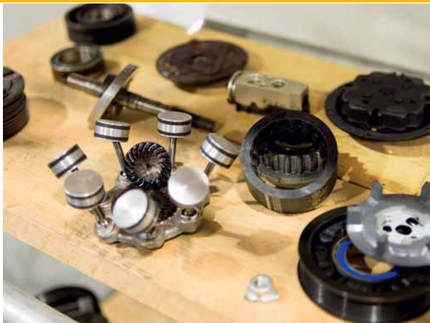
Als u wilt weten wat er allemaal kan misgaan aan een aircocompressor, heeft Harberink een mooie verzameling schadepdelen om zijn brede ervaring te demonstreren.
